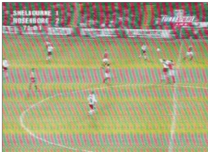
Wenn es auf Nachbars Fernsehbildschirm bei der für ihn wichtigsten Nebensache der Welt infolge der Tätigkeit eines Funkamateurs so aussieht, sind das Störungen – und es steht Ärger ins Haus. Welche Zusammenhänge für das Zustandekommen eine Rolle spielen, und was man gegen Störungen tun kann, soll dieser Beitrag verdeutlichen.
