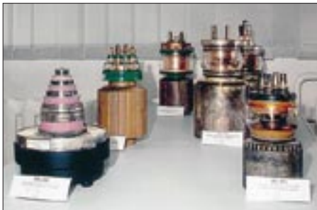
Luftgekühlte Sendetridoden und -tetroden bis 10 kW im Sender- und Funktechnikmuseum Königs Wusterhausen Foto: DL6AKC
