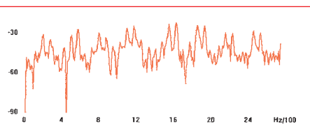
Bild 3: MFSK-8-Kanal-Signalspektrum (14,124 MHz), wobei FFT Mark und Space erkennbar macht
