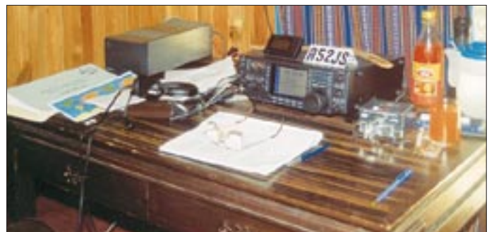
Die Station von A52JS, ein IC-756 „barfuß“ mit 100 W Ausgangsleistung
