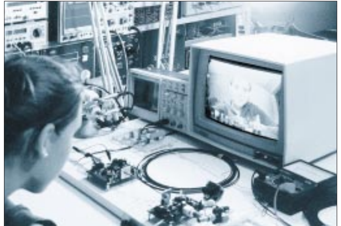
Bild 10: Eine Videoubertragung mit der LWL-Station
